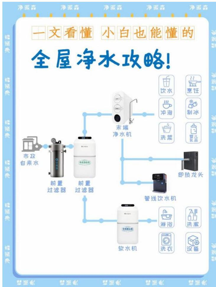
全屋净水系统通常包含四级处理：前置过滤器拦截泥沙铁锈，中央净水机去除余氯和有机物，中央软水机软化水质，末端直饮机精准过滤重金属和细菌。例如，前置过滤器可保护后续设备延长寿命，软水机则能减少热水器水垢，提升洗涤效果。
